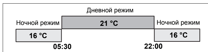
Рис. 9 Нормальный (дневной) отопительный режим и отопительный режим с пониженной температурой (ночной режим)
